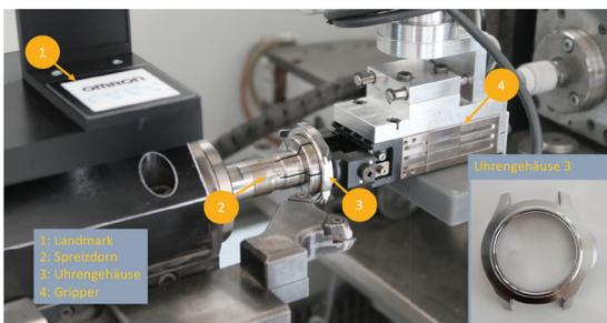
Abb. 1 Übersicht der Komponenten für das Platzieren eines Uhrengehäuses
