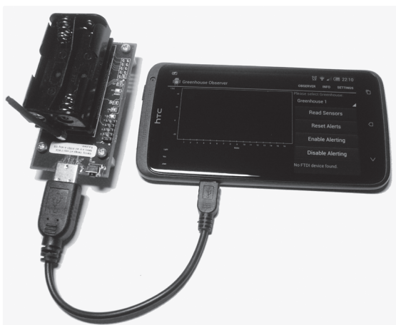
Android Smartphone als USB Host mit MIB520 Mote Interface Board
