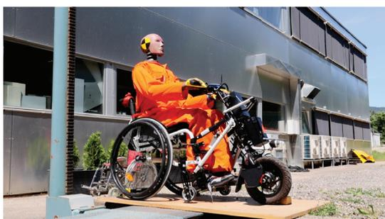
Versuch: Bestimmung lateraler Kippwinkel Lipo Lomo Micro
