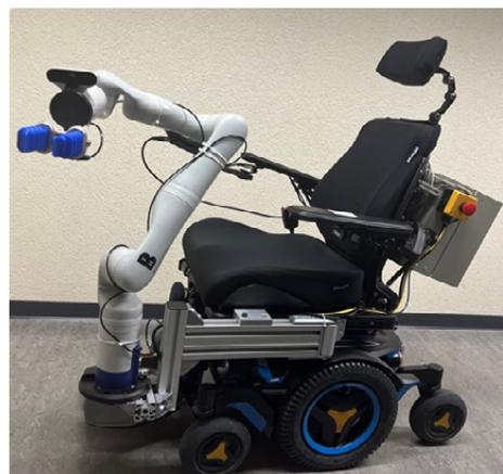
Abbildung 2: Gebauter Prototyp mit Schnittstelle zwischen Rollstuhl und Roboter
