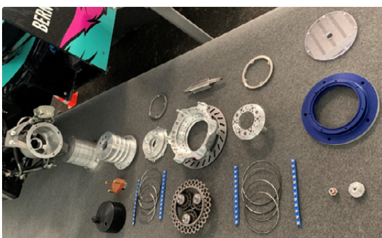
Radnabenbaugruppe des BRT-Rennautos Saison 2022/2023
