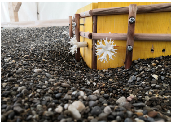
Versuchsaufbau, Kolkbildung unterhalb der Wurzelteller
