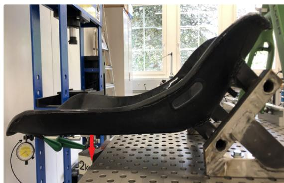
Déformation mesurée : 1,19mm
