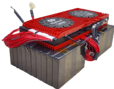
Entwickelte und validierte 48 V LTO-Batterie
