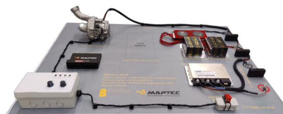
eBooster Demo- und Testplattform eBoostLab48
