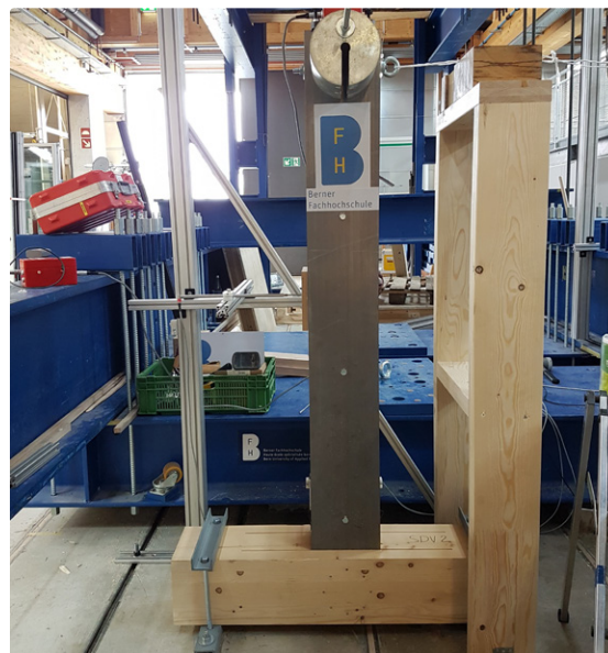
Ausschwingversuch an einem Prüfkörper mit Stabdübelverbindung.
