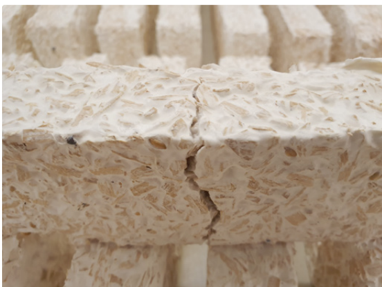
Prüfkörper aus Pilzmyzel-gebundenen Buchenspäne nach der Biegeprüfung.
