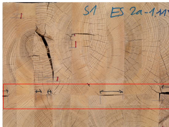
Abb. 2: Ausschnitt Delaminierungsprüfkörper mit nicht optimaler Verklebungsqualität
