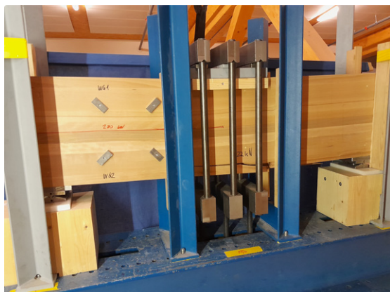
Abb. 1: Schubprüfung mit mittig angeordneter Blockfuge
