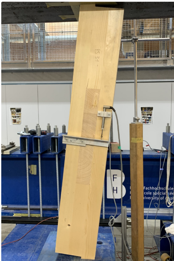
Versuchsaufbau zur Festigkeits- und Steifigkeitsermittlung
