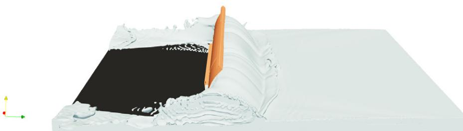
2-Phase Simulation der Variante I - 1s5s0B [150 mm Schneehöhe, 2650 mm Räumbreite,  $v = 7$  km/h]
