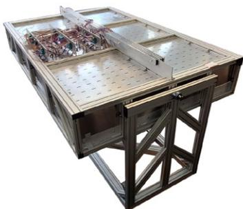
LED-Sonnensimulator mit einem aufgebauten und verkabelten LED-Element
