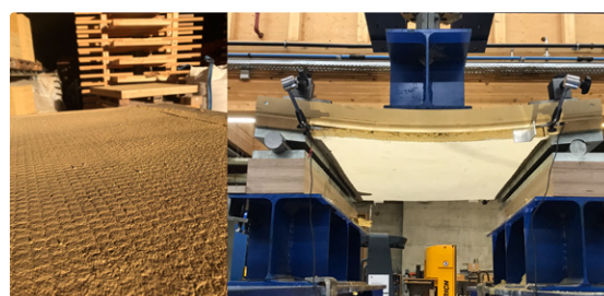
Links: Lehm-Element nach deren Herstellung; Rechts: 3-Punkt-Biegeversuch eines Lehm-Elementes
