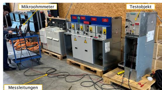
Abbildung 1: Versuchsdurchführung Siemens 8DJH, BKW Standort Luterbach SO
