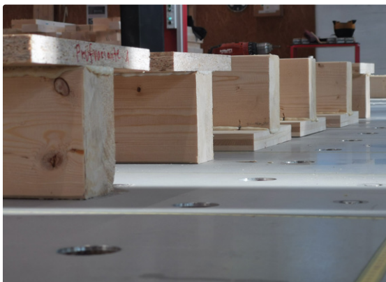
Prüfkörper mit unterschiedlichen Beplankungsmaterialien, Klebstoffen und Verbindungsmittel
