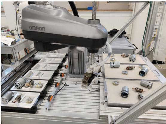
Aufbau AT1: Werkstückträger, Materialzuführung und SCARA-Roboter
