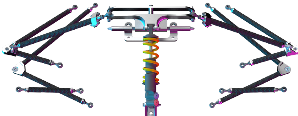
Vogelperspektive der neuen Radaufhängung mit zentraler Feder-Dämpfereinheit und integriertem Kurvenstabilisator
