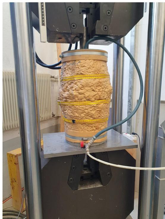
Vakuumtriaxialversuch während des Schervorganges
