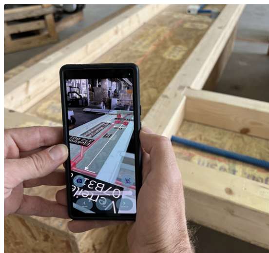
Anwendung des Augmented Reality-Systems in der Elementproduktion (Quelle: eigene Darstellung)
