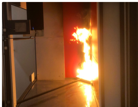
SBI-Prüfstand zur Klassifizierung des Brandverhaltens von Bauprodukten
