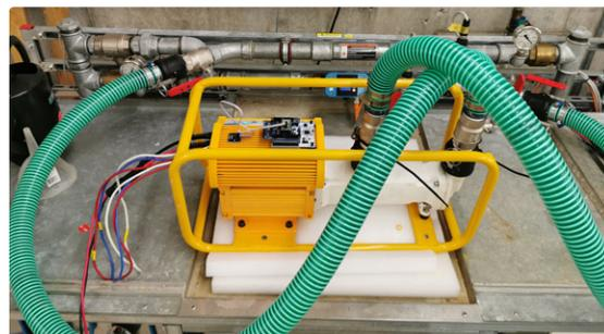
Abbildung 1: Prüfstand und Solar-Wasserpumpe, womit die beiden Machine Learning Ansätze getestet wurden
