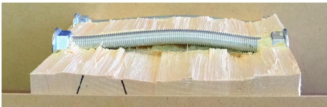
Knickversagen eines Prüfkörpers
