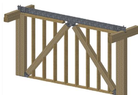
Fachwerk V2: Parallel zur Deckenspannrichtung
