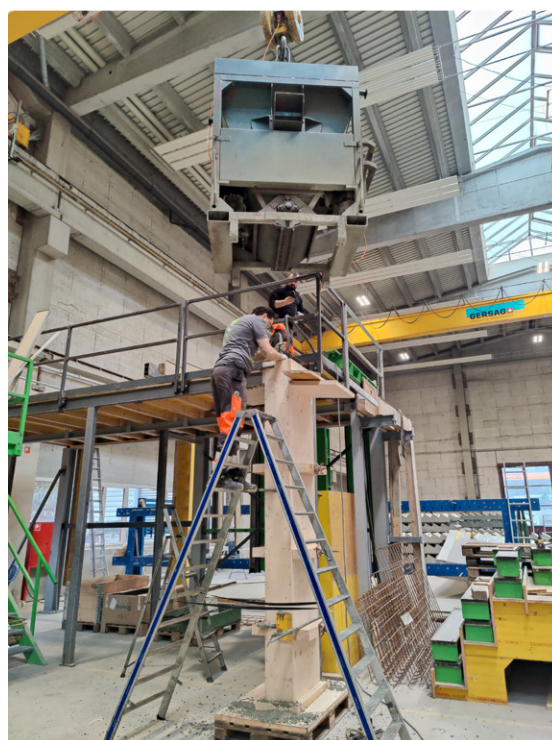
Versuchsaufbau wird mit Beton ausgegossen und verdichtet
