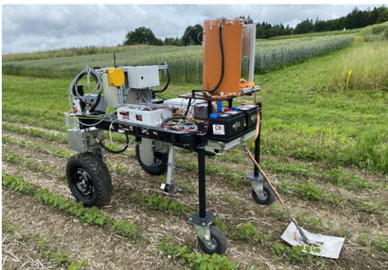
Das Trägerfahrzeug behandelt in einer Feldreihe erkanntes Unkraut mit Hochspannungspulsen.
