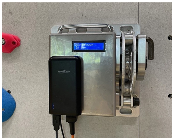
Der weiterentwickelte nExt-Climber mit Powerbank zur Stromversorgung des Arduino-Controllers.
