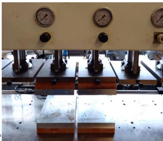
Hydraulikpresse zum Pressen des Formsperrholzes (Werkzeug nicht sichtbar aufgrund Geheimhaltung)
