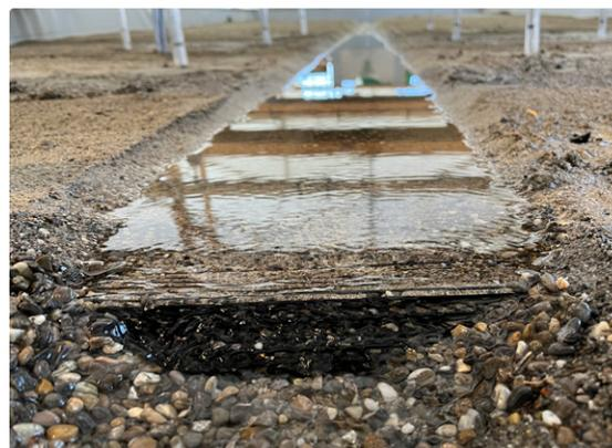
Laufender Versuch mit dem Biberdamm im Massstab 1:30
