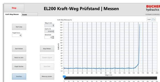
Abbildung 2: Ansicht des Prüfprogramms mit einem Kraft-Weg Diagramm.
