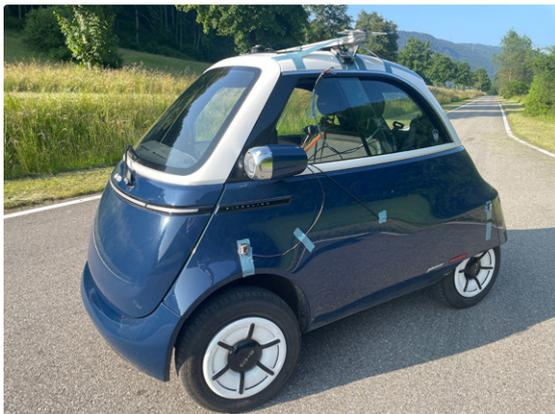
Microlino mit installierter Messtechnik
