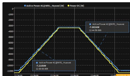
Tertiärregelenergie gemäss PV4Balancing-Anforderungen von Swissgrid: 10 Minuten Rampen, Abregelung auf 30 %.
