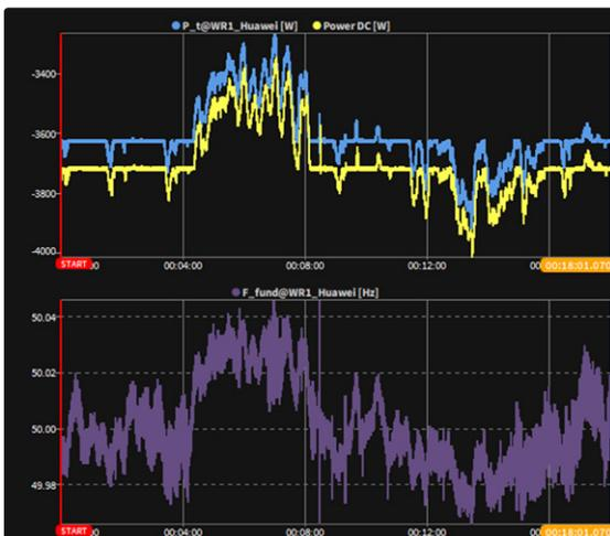
Primärregelleistung eines Wechselrichters: P(f)-Regelung, mit Totband zwischen 49,99 und 50,01 Hz.
