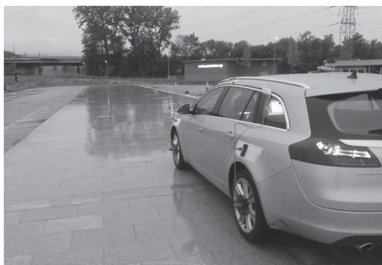
Test de freinage avec coefficient d'adhérence homogène bas
