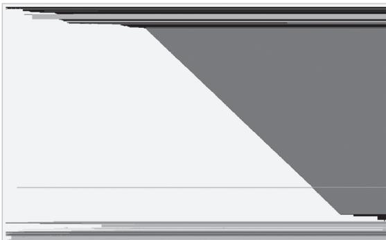
Memory Tracing über die Laufzeit eines Prozesses. Ein detektierter Heap Spray ist in grau sichtbar.
