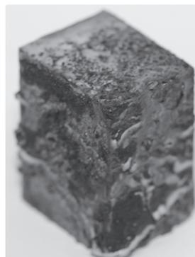
Abb. 1: Probe aus GJL-250 (Gushaut vor dem Test mechanisch entfernt) nach 210 h Salzsprühnebeltest
