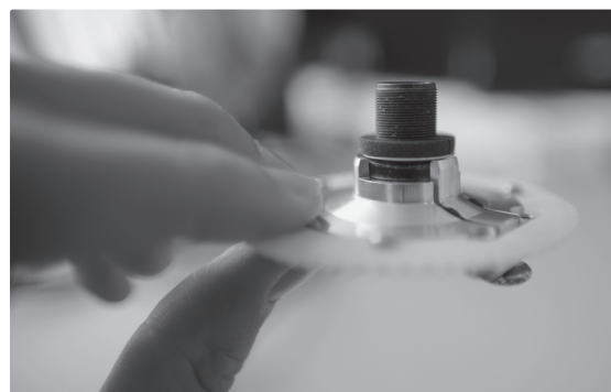
Die Linse mit dem Schaumstoffring, gegriffen vom Linsengreifer
