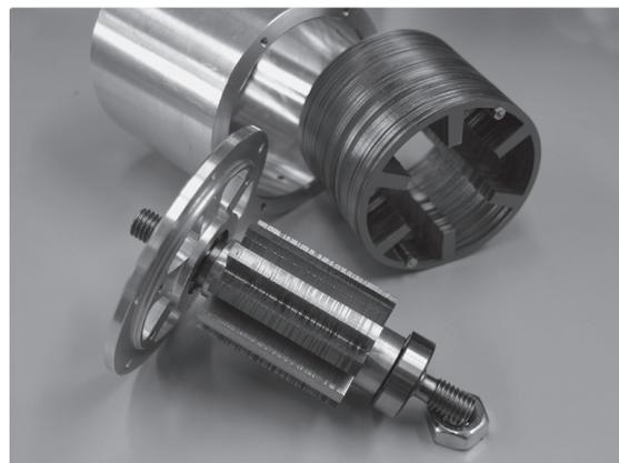
Bild 2: Montage der Stator- und Rotorbleche des Prototypen (hier noch ohne Wicklungen)
