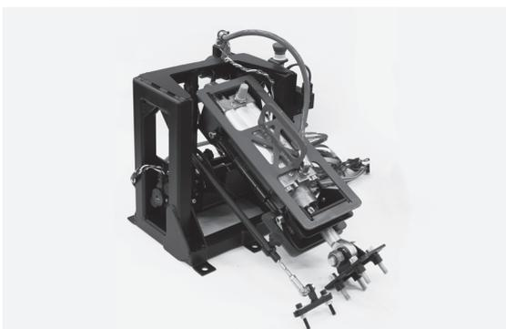
Brems- und Fahrpedalbetätigung bereit zum Einbau ins Fahrzeug
