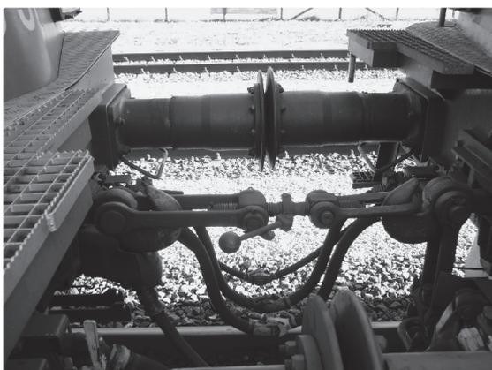
Kupplungsstelle mit UIC-Schraubenkupplung und Puffer (Quelle: B. Lämli)
