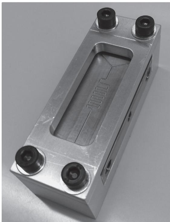
Der selber konstruierte Mikroreaktor mit Glasplatte, eingespannt in den Aluminiumrahmen
