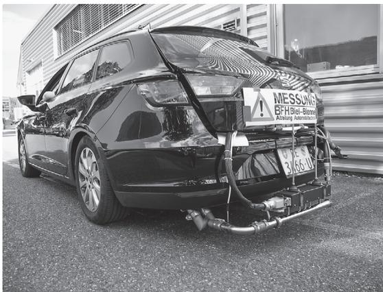
Abbildung 1: Messaufbau für die Strassenmessung.
