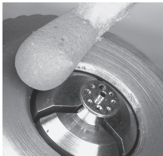
Das Referenzstück in einer Spannzange eingeklemmt
