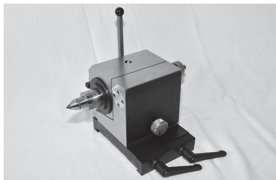
fertig montierter Reitstock
